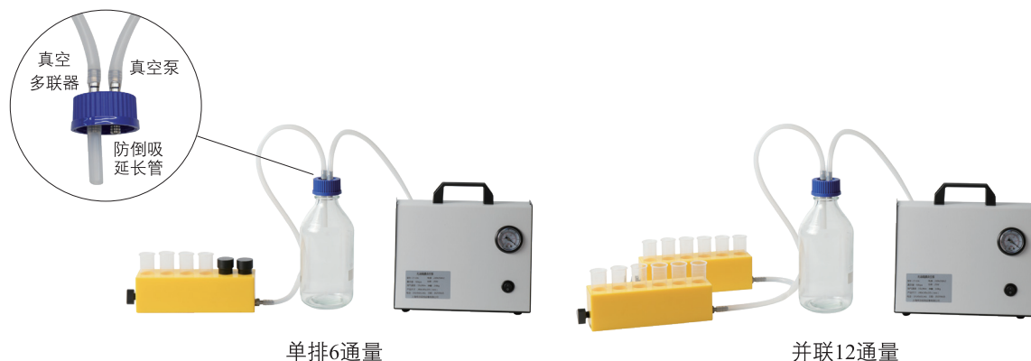
图二. 真空多联器、真空泵和废液瓶连接示意图
